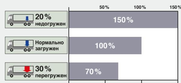
Износ шин зависит от веса перевозимого груза. Компания YOKONAMA рекомендует равномерно распределять вес по осям и соблюдать нормы загрузки.
