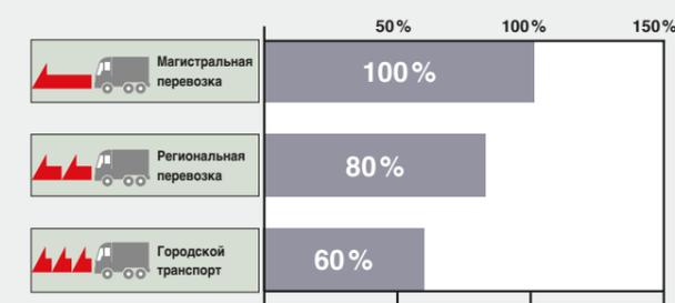
Эксплуатация шин в режиме частых торможений приводит к дополнительным нагрузкам и повышенному износу. YOKONAMA рекомендует спокойный стиль вождения, прохождения поворотов и плавное торможение, особенно в условиях города и на региональных дорогах.
