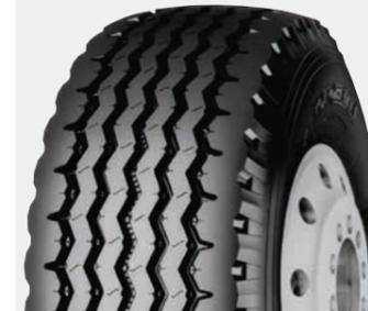
Широкопрофильная шина для магистрального/регионального применения разработана для установки на оси полуприцепа.
